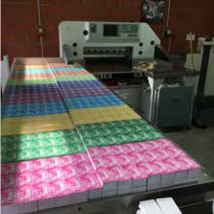
Unsere Stärke: Karten in allen möglichen Formaten kostengünstig produzieren. Hier sieht man das Spiel Ein mal Eins vorbereitet fürs Ecken abrunden und anschließendes Konfektionieren.
